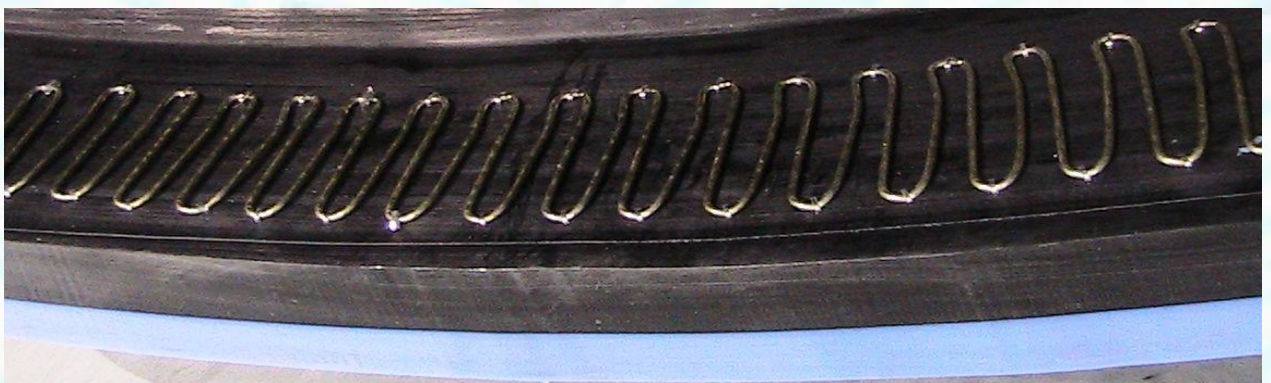
Рис.7. Закладной электрофузионный элемент
