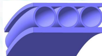
Рис.3 Стенка трубы трёхслойная в разрезе
